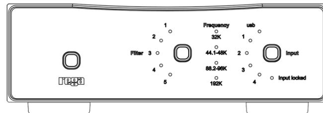
**Interrupteur marche/arrêt (juste au dessus du logo Rega)** Appuyez sur l'interrupteur pour mettre l'appareil sous tension. Le logo Rega s'allume.
