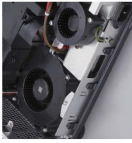
Nouvelle structure de refroidissement qui rend le HC5000 inaudible en fonctionnement.
